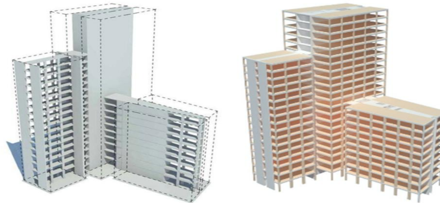
Estructura hormigón + Madera
